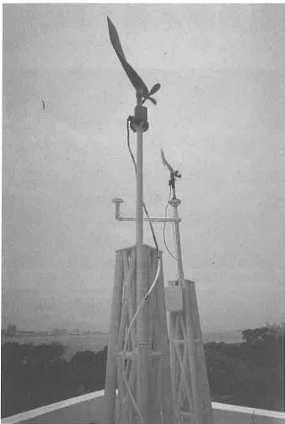
裝設於風力塔頂之螺旋槳式風向風速儀。
