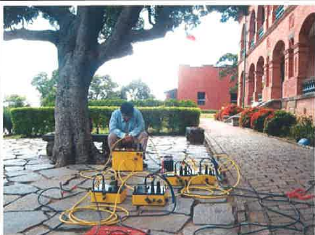
圖 B-11 三維地電阻影像剖面探測 現場施測-3
