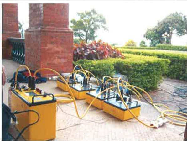
圖 B-10 三維地電阻影像剖面探測 現場施測-2
