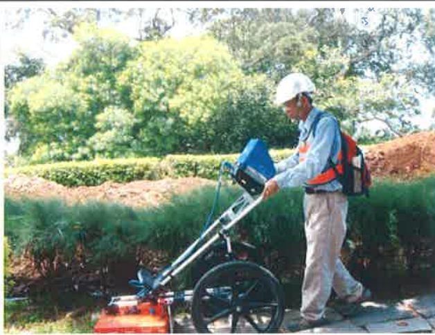
圖 B-4 透地雷達現場施測-4
