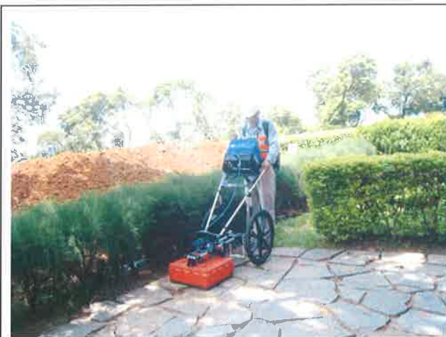
圖 B-1 透地雷達現場施測-1
