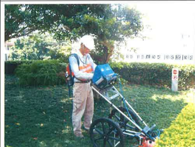
圖 B-3 透地雷達現場施測-3
