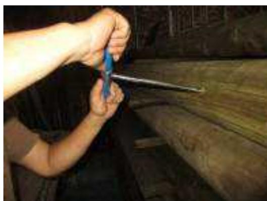
照片 6-104 木構件真空加壓防腐處後取樣
