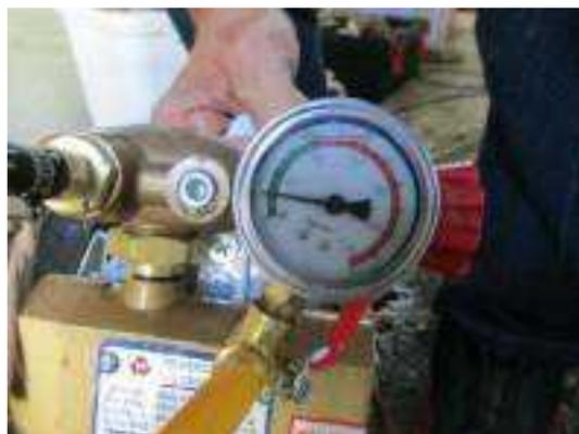
照片 6-114 舊木構件蟲蟻防治藥劑灌注壓力檢查
