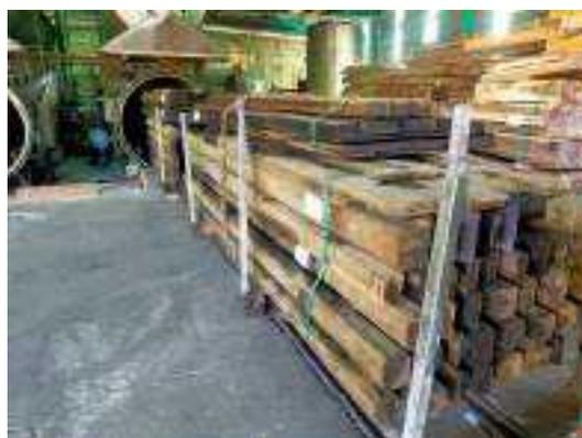
照片 6-102 木構件進真空加壓防腐處理完成
