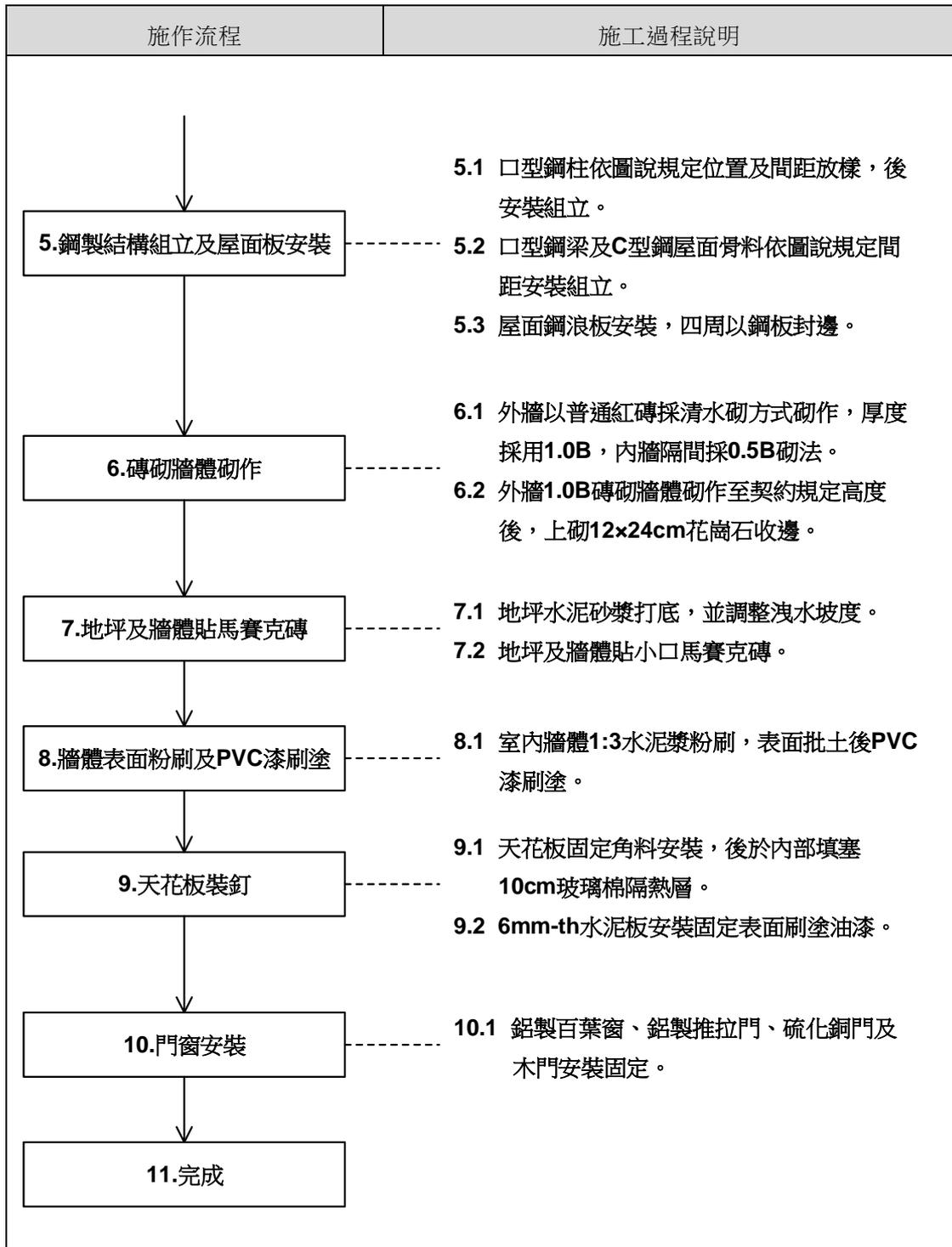
圖 6-4 服務空間之管理室及廁所新建工程施工流程圖
