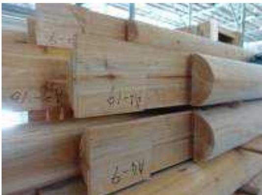
照片 6-99 木構件真空加壓防腐處理前完成樺頭加工
