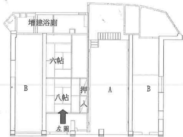
【圖 3-2-8】前棟作為日式宿舍之室內配置推測圖，中央開間以牆隔開分屬左右使用
