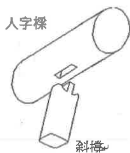
【圖 5-3-10】斜撐接樑細部
