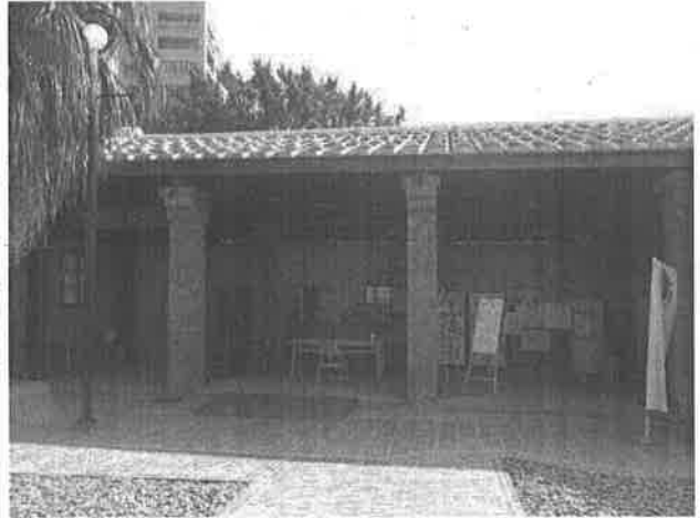
【圖 3-3-21】嘉士洋行 A 棟倉庫，正立面僅有磚柱支撐屋架，無立面牆
