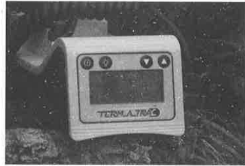
圖12 Termatrac偵測淡水紅毛城庭園腐朽木下之白蟻，儀表顯示白蟻活躍
