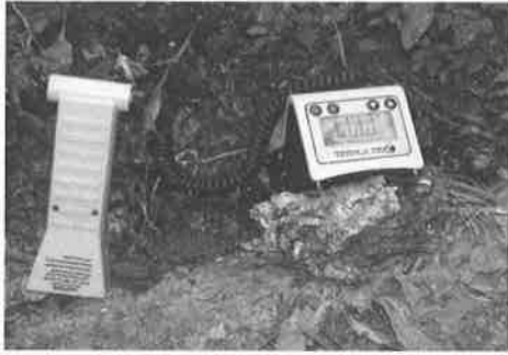
圖11 Termatrac偵測淡水紅毛城庭園腐朽木下之白蟻
